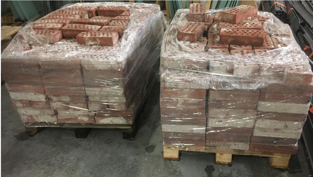
Kuva 15: tiilien pakkaamista, kuorman parempaan vakauteen päästään limittämällä joka toisen kerroksen saumat eri kohtaan.
