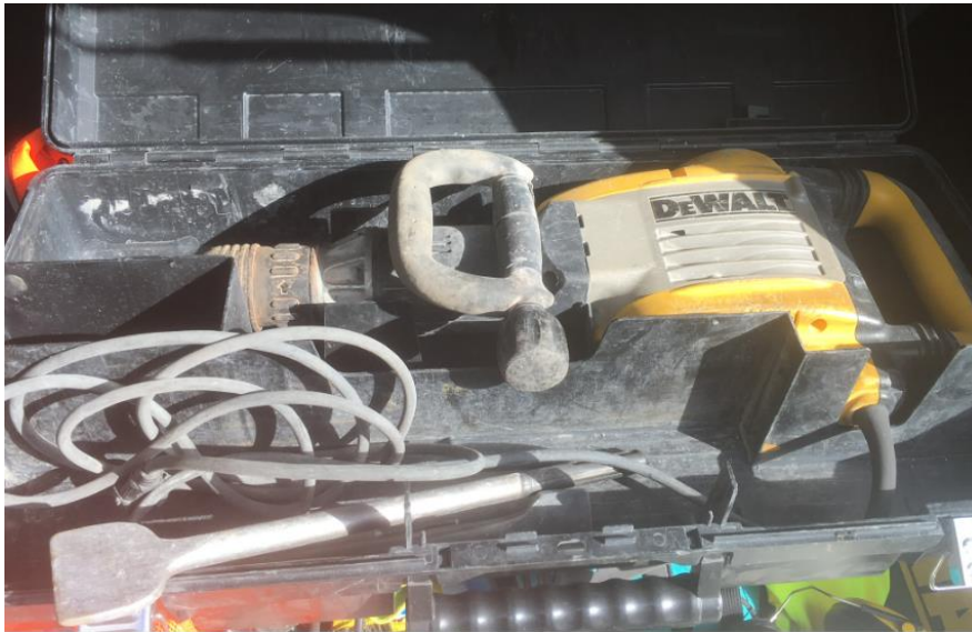
Kuva 9: Käsiniirrotuksessa käytetty iso piikkauskone
