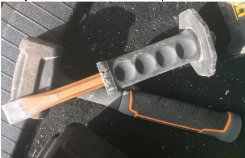
Kuva 7: Käsin irrotukseen käytetyt taltta ja moska
