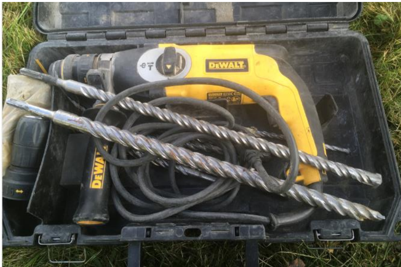
Kuva 8: Käsin irrotuksessa käytetty pieni piikkauskone
