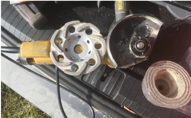
Kuva 12: Puhdistusvälineenä kulmahiomakoneeseen kiinnitettävät timanttilaikka ja hiontakivi. Muita välineitä oli rahi, teräsharja ja muurarinvasara.
