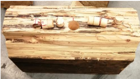
Kuvat 9 – 13. Liimapalkit ja poratappinäytteet.
