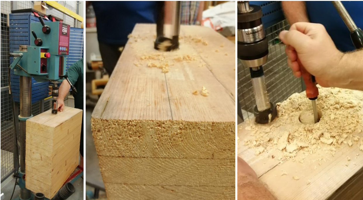
Kuvat 5, 6 ja 7. Poratappinäytteiden poraus.
