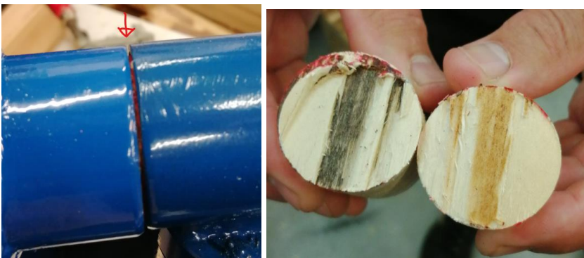
Kuva 7 ja 8. Koekappale leikkauskojeessa. Sauma nuolen kohdalla. Leikkautunut liimasauma.
