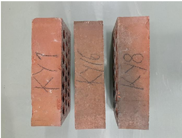
Kuva 1. Laboratorioon toimitettuja tiilinäytteitä. Näytteisiin on merkattu niissä ennen testausta havaitut vauriot, lohkeamat ja halkeamat.
