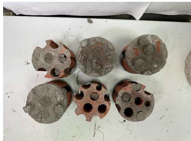
Kuva 5. Kappaleet vetolujuuden testauksen jälkeen.
