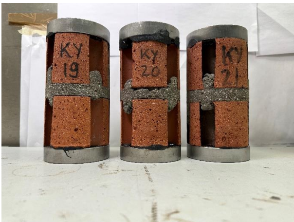
Kuva 4. Testatut kappaleet ennen vetolujuuden testausta.
