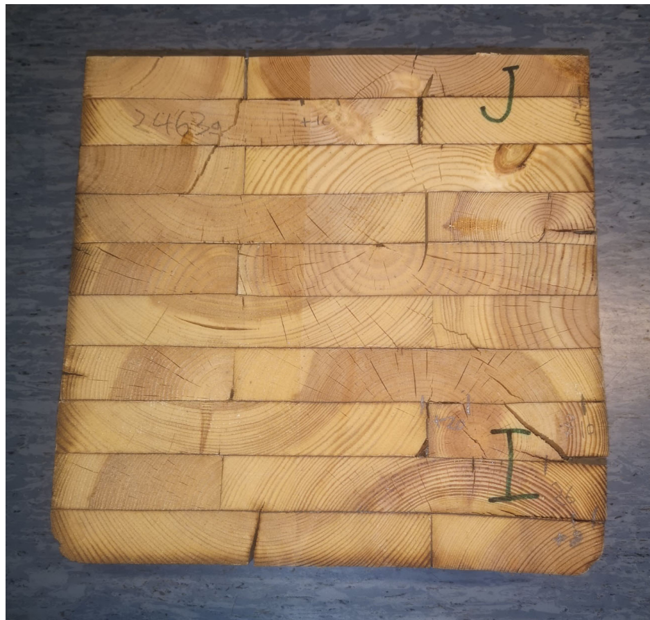
Palkki J -I delaminoinnin jälkeen
