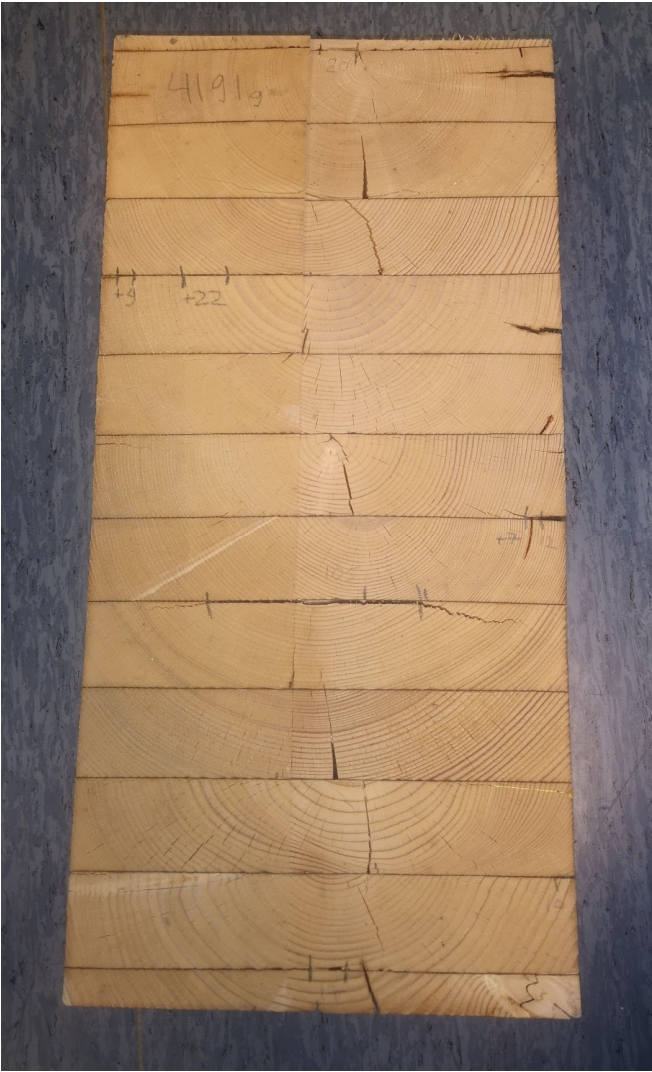
Palkki C -D delaminoinnin jälkeen
