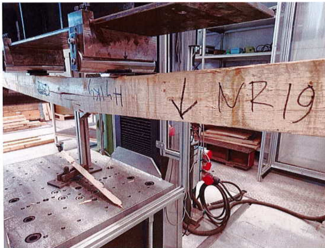
Kuva 16. Kappale Nro 19. Mekaaninen vaurio. Naulojen lohkaisema särmä. Visuaalisesti lajiteltu hylkyyn. Kimmomoduuli taivutustestissä testiryhmän korkein 15 047,2N/mm 2 ja taivutuslujuus 68,7N/mm 2 . (C45 EN338 mukaan)
