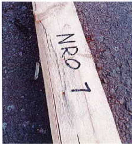
Kuva 14. Kappale Nro 1 hylky, mekaaninen vaurio. Kimmomoduuli 11002,5 N/mm 2 . (C24) EN 338 mukaan. Taivutuslujuus 47,6N/mm 2 . Taivutuslujuudella tarkoitetaan materiaalin kykyä kestää murtumatta taivutusvoimia eli rasituksia, jotka pyrkivät taivuttamaan materiaalin. Se mittaa, kuinka paljon taivutusjännitystä materiaali kestää ennen murtumista.
