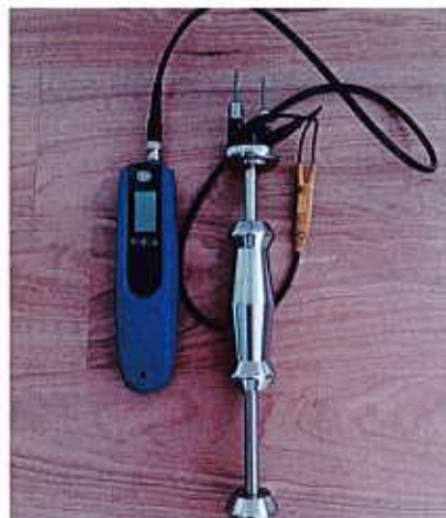
Kuva 7. Mikkeliin Mikropoliksen tutkimusyksikköön toimitettiin 20 kpl 50*100 sahatavaraa. Jokaisesta kappaleesta arvioitiin lujuusluokka sekä lujuusluokan määrittävä ominaisuuden raja-arvo INSTA – 142 standardin mukaisesti. Kosteus mitattiin Gann HT70 sähköisellä vastusmittarilla.
