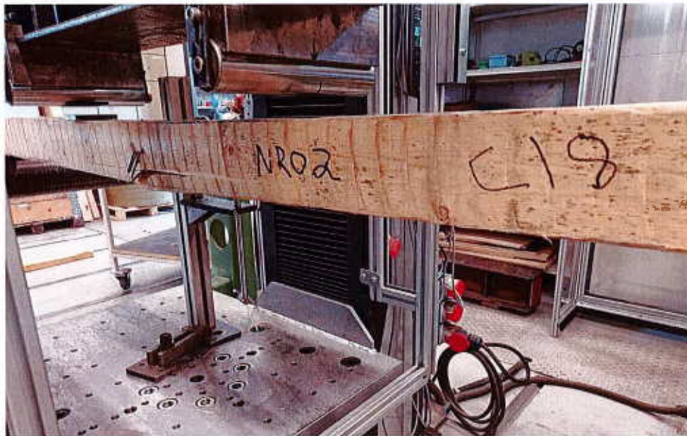
Kuva 15. Kappale Nro 2, visuaalisesti lajiteltu oksasumman mukaan C18 luokkaan. Kimmomoduuli 12 260,6 N/mm 2 . C30, EN 338 mukaan. Taivutuslujuus 54N / mm 2 .
