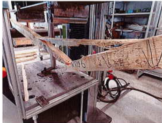
Kuva 13. Kappale Nro: 6 mekaaninen vaurio Hylky, visuaalinen lajittelun ohjeiden mukaan. Taivutustesti lujuus 38,8 N/mm 2 . Jäykkyysarvo 8 887,5 N/mm 2 (C16, EN338) Kimmomoduulin avulla voidaan arvioida materiaalin jäykkyyttä: mitä suurempi kimmomoduuli, sitä jäykempi materiaali on ja sitä vähemmän se venyy annetulla jännityksellä.
