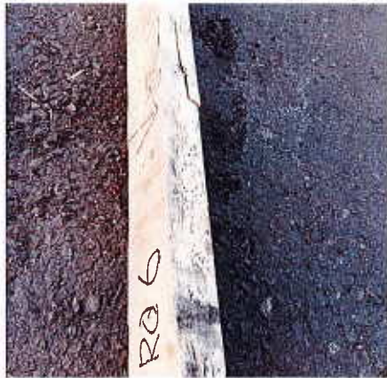
Kuva 13. Kappale Nro: 6 mekaaninen vaurio Hylky, visuaalinen lajittelun ohjeiden mukaan. Taivutustesti lujuus 38,8 N/mm 2 . Jäykkyysarvo 8 887,5 N/mm 2 (C16, EN338) Kimmomoduulin avulla voidaan arvioida materiaalin jäykkyyttä: mitä suurempi kimmomoduuli, sitä jäykempi materiaali on ja sitä vähemmän se venyy annetulla jännityksellä.
