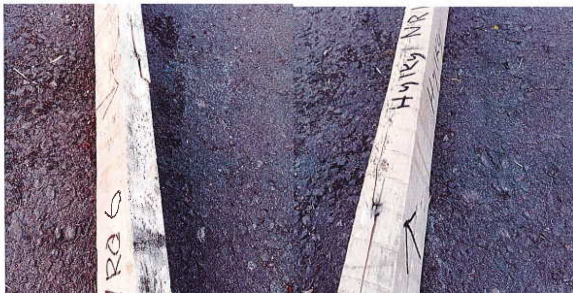
Kuva 8. Hylkyyn lajitellun tavarän suurimpana tekijänä oli mekaaninen vaurio. Testikappaleiden valinnassa huomioitiin ja korostettiin niitä ominaisuuksia, jotka syntyvät purkutyömalla purkamisen ja siirtojen tuloksena.
