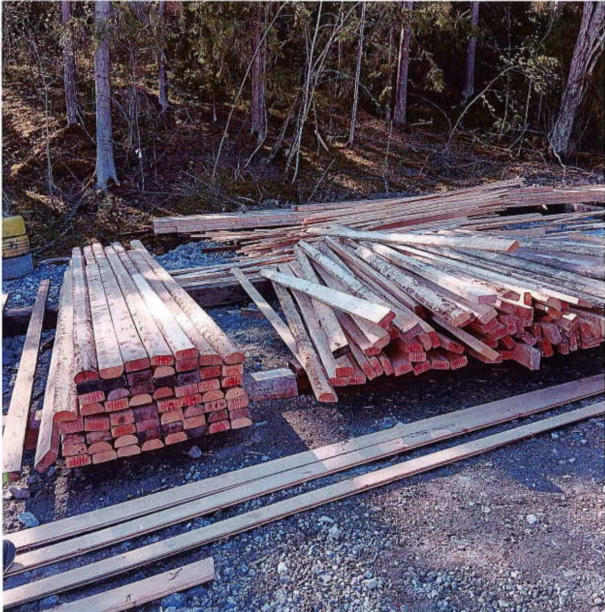
Kuva 4. Kuvan vasemmalla puolla oleva nippu oli esilajiteltu jatkokäyttöön. Oikealla puolella oleva nippu sisälsi runsaammin mm. naulojen aiheuttamia mekaanisia vaurioita.
