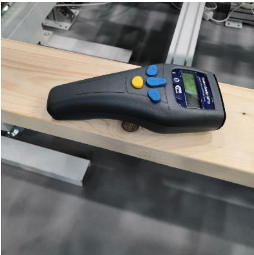
Timber Grader MTG, kuvattuna Ligna messuilla 2023. Kuva Jouni Silvast. Laitteisto on hyväksytty käytettäväksi EN 14081 standardin mukaisena koneellisena lujuusluokituslaitteena (machine grading) joissakin versioissa ja on listattu EN 14081-4 yhteydessä.
