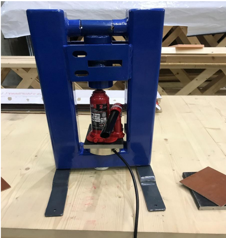
Kuva 1. Liimasauman työmaatestikehikko, tunkki ja kuorma-anturi.
